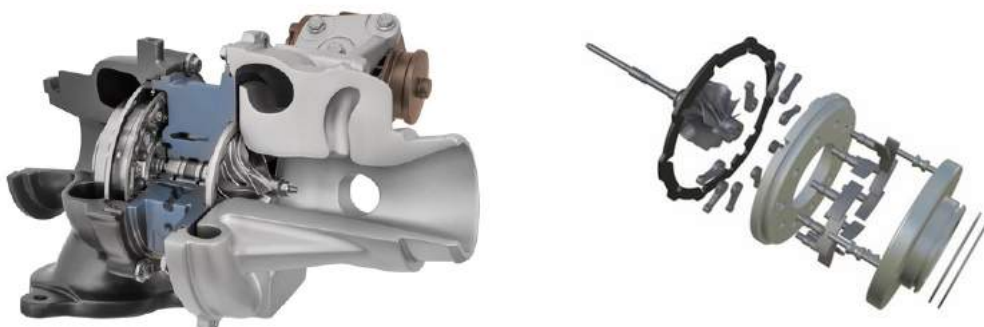
GARRETT VARIABLE GEOMETRY TURBO (VNT™) TECHNOLOGIE VARIABILNÍ GEOMETRIE LOPATEK
