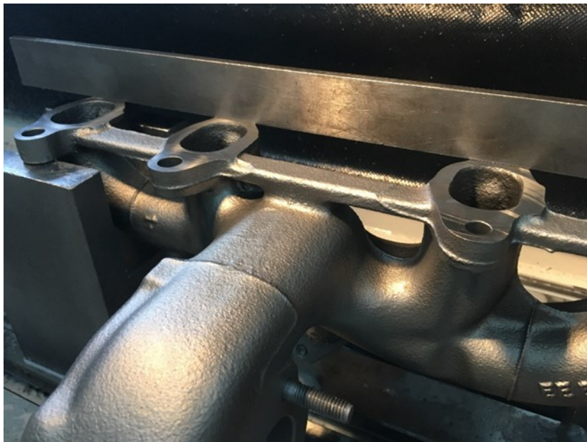
Ukázka opravených svodů turbínové skříně
