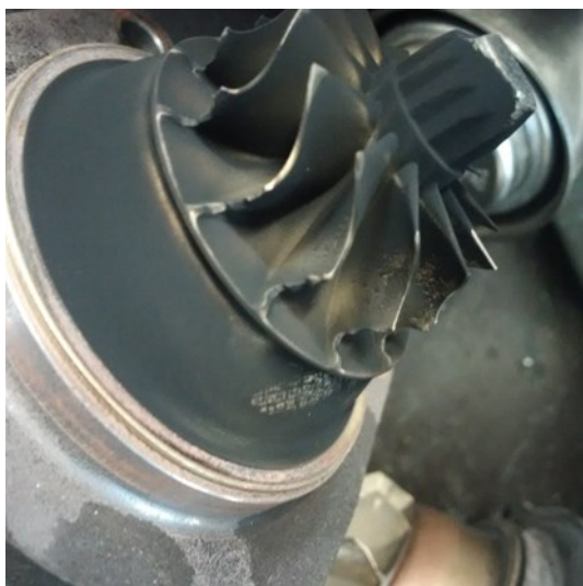
Poškozené turbínové kolo vniknutím většího cizího tělesa
