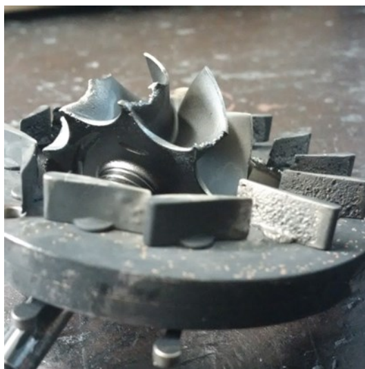
Poškozené turbínové kolo a natáčecí lopatky vniknutím cizího tělesa
