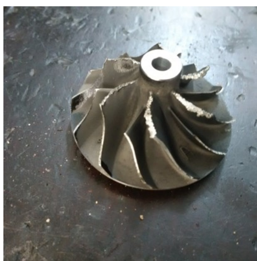
Poškozené dmychadlové kolo vniknutím většího cizího tělesa
