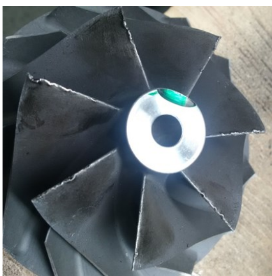
Poškozené dmychadlové kolo vniknutím menšího cizího tělesa
