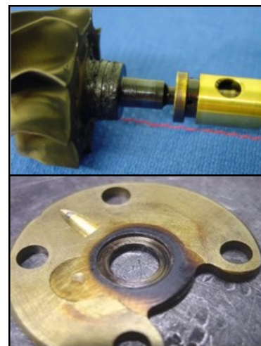
Poškození rotoru a ložisek způsobené nezaolejováním turbodmychadla během instalace
