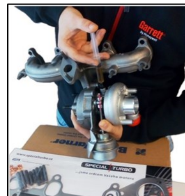
Zaolejování turbodmychadla je podstatné k jeho následnému bezproblémovému provozu.
